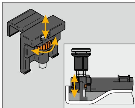
Durch herausschrauben/ hineinschrauben der Stellmutter werden die Eckpunkte des Montagerahmen auf parallel zum Wannrand eingestellt.
