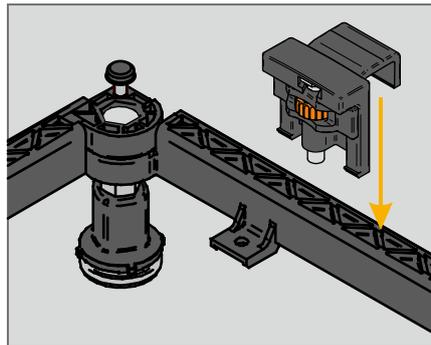
Der Höhenausgleich ist sowohl auf der Auflage Mitte, als auch auf den Winkelarmen (EVO 1200) und den auf 180° montierten Winkelarmen beim Erweiterungs-Set EVO 2000 aufsteckbar.
